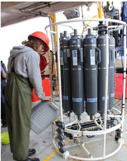
Figure 7. Échantillonnage d'eau pour les mesures de chlorophylle a , de pigments par HPLC, d'abondance de pico- et nano-eucaryotes et taxonomique du phytoplancton. © Virginie Galindo
