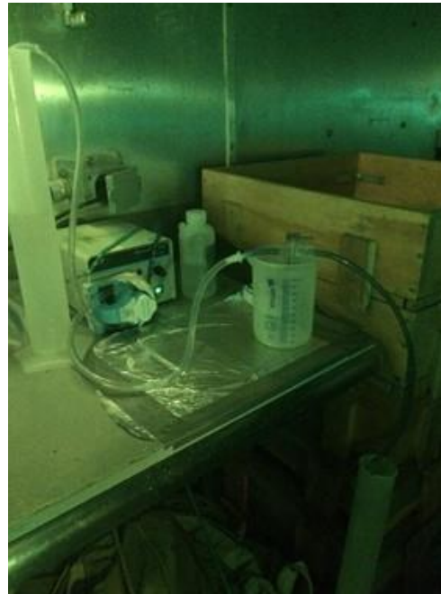
Figure 6. Système de filtration servant à l'analyse de la diversité des communautés bactériennes hydrocarbonoclastes. © Virginie Galindo
