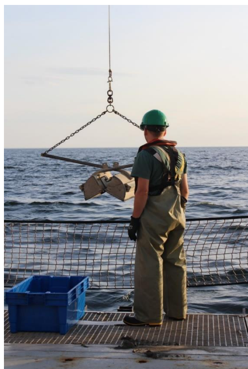
Figure 11. Échantillonnage à la benne Van Veen © Virginie Galindo
