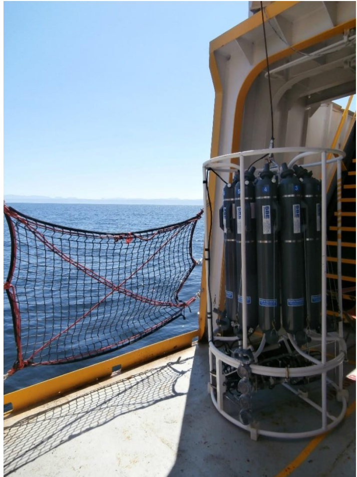
Figure 2. Rosette de 12 bouteilles équipée d'une sonde «Conductivity Temperature Depth (CTD) de l'Institut des sciences de la mer de Rimouski. © Virginie Galindo
