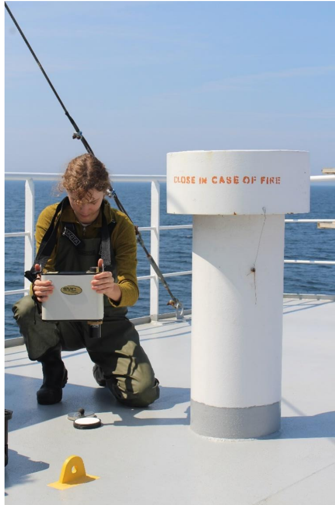
Figure 3. Mesures de réflectance spectrale et de radiance directe du soleil ainsi que de l'épaisseur optique d'aérosol à l'aide du SVC par Alycia Boismenu. © Virginie Galindo
