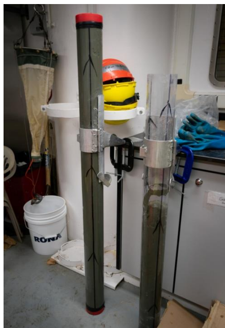
Figure 13. Récupération d'un carottier à gravité (à gauche) et manipulation des carottes dans le laboratoire de géologie du navire (à droite) © Jean-Carlos Montero-Serrano.
