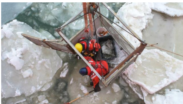
Figure 14. Récupération des blocs de glace de mer chargée de sédiments à partir de la cage © Safouane Khamassi.
