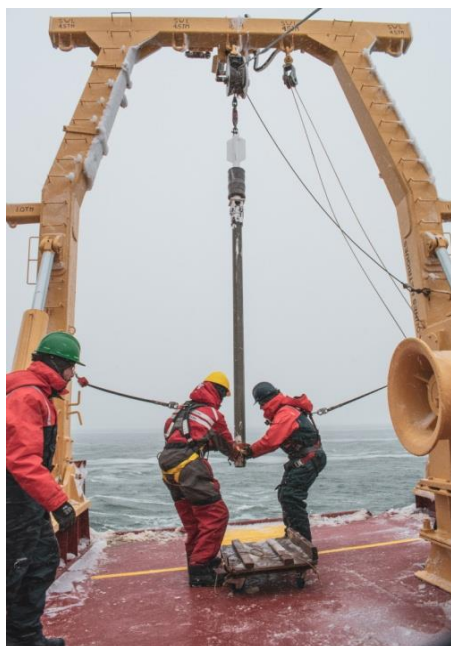
Figure 13. Récupération d'un carottier à gravité (à gauche) et manipulation des carottes dans le laboratoire de géologie du navire (à droite) © Jean-Carlos Montero-Serrano.
