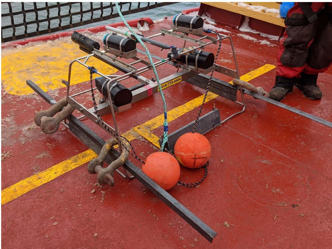
Figure 44. Système de caméras vidéo sous-marines appâtées (CVSA) modifié avec barres de fer
