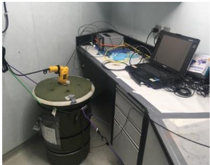
Figure 27. Incubation de carottes de sédiment dans un incubateur. La perceuse fixée sur le dessus de l'incubateur permet, grâce à un système d'aimants, de mélanger l'eau surnageante dans chaque carotte de sédiment afin d'éviter la stratification dans la colonne d'eau.
