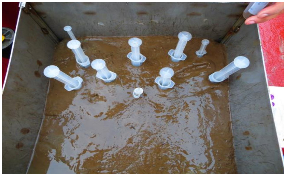
Figure 16. Échantillonnage par seringues de la méiofaune et des phytodétritus dans le carottier à boîte
