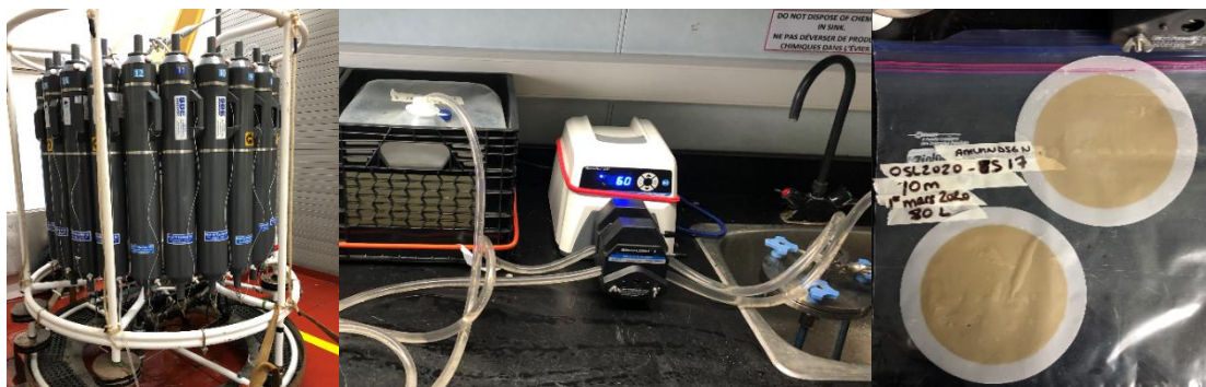
Figure 9. Rosette et sonde CTD (gauche), système de pompage (centre) et filtres mis à sécher (droite) © Anne Corminboeuf
