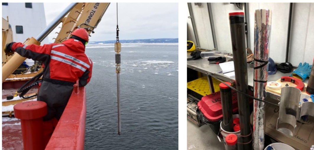
Figure 22. Récupération d'un carottier à gravité (à gauche) et manipulation des carottes dans le laboratoire de géologie du navire (à droite). © Anne Corminboeuf
