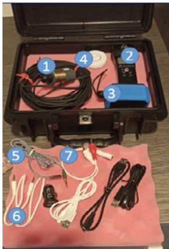
Configuration de base : Hydrophone + Enregistreur + HP
